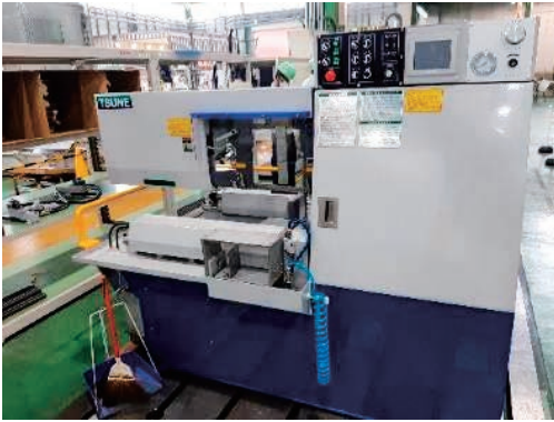
必要に応じて、除染の前処理として除染対象物を単純形状に加工する切断装置
