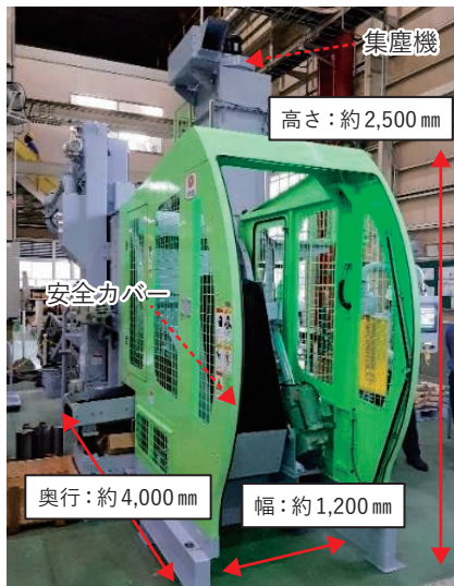
入り組んだ解体材や処理が困難な配管サポート、小口径の配管を縦割りにした半円形状のものなどを円滑に除染するための自動除染装置
